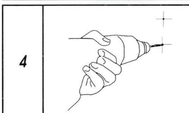
4 Effectuer avec précision les trous dans le mur et insérez les chevilles adéquates.
