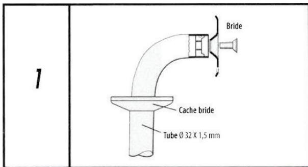
1 Insérer les caches brides sur la barre d'appui et fixer les brides de fixation au mur sur chaque extrémité (en utilisant les vis fournies dans le paquet).
